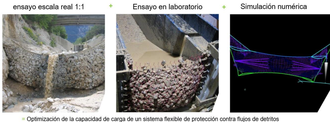
Figura 42. Optimización de la capacidad de carga.
